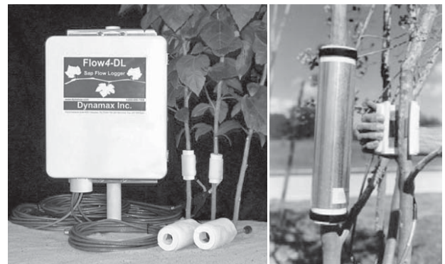
図3 サップフローシステム 写真提供 (株)メイワフォーシス
