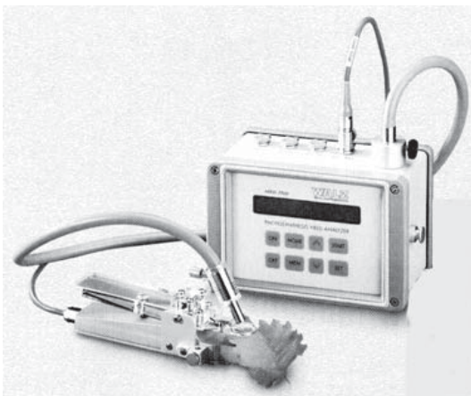
図2 クロロフィル蛍光測定装置miniPAM 写真提供：ナモト貿易(株)
