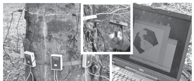
図8 ピカス 左：センサー、中：ハンマー、右：診断画面
