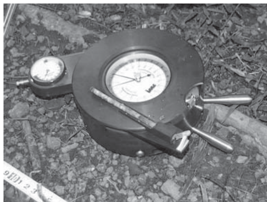
図5 フラクトメータII 中央目盛の手前に材のコアをはさんでいる
