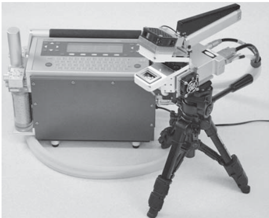
図1 光合成蒸散測定システムLI-6400 写真提供：(株)メイワフォーシス
