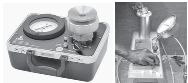
図4 プレッシャーチャンバ（携帯型と据置型） 左写真提供：(株)メイワフォーシス
