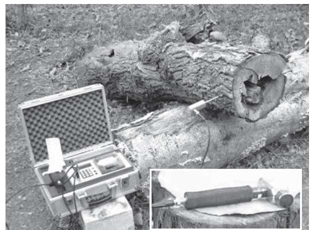
図7 インパルスハンマー 右下枠：ハンマー部分
